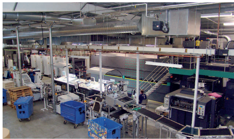
16 Seiten Rollenoffsetmaschine POLYMAN 45
